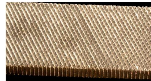
Detalle de los dientes de una lima
